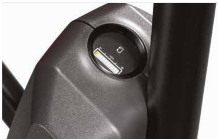
Indicateur de décharge de batterie (HHL100)
