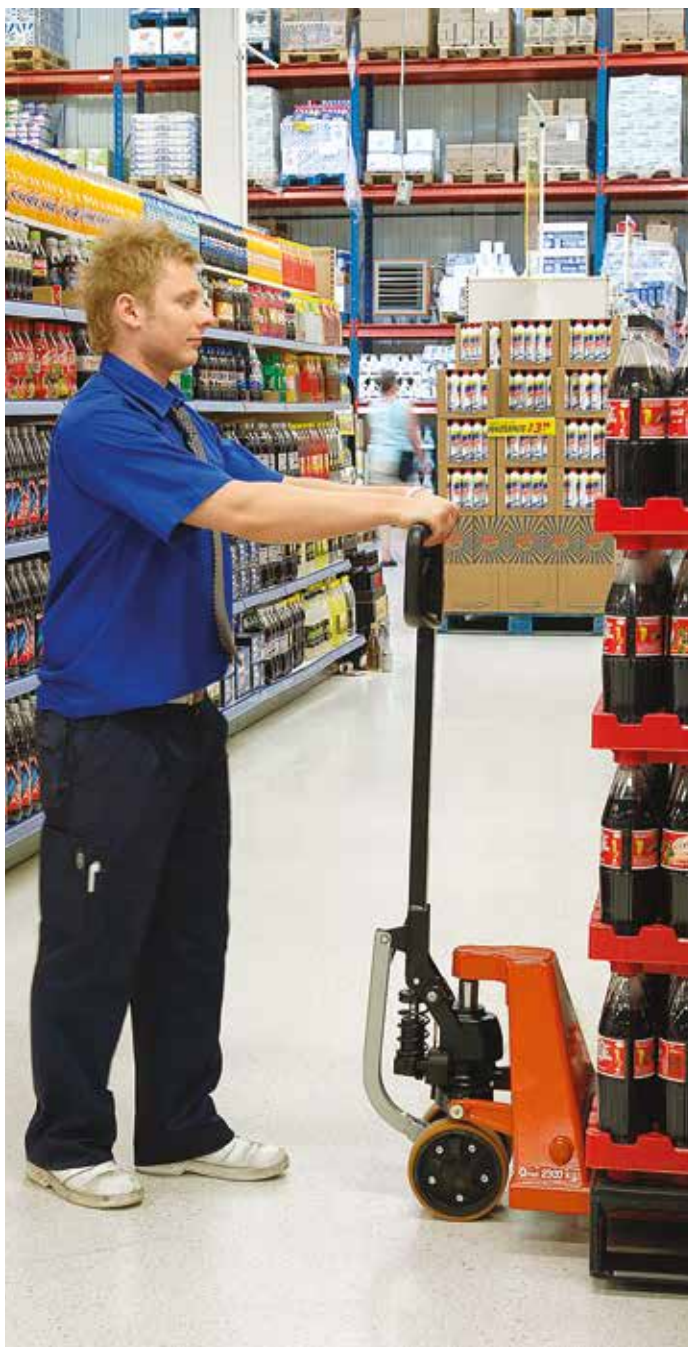
Le timon du BT Pro Lifter effectue un transfert de force vers les roues qui déclenche le mouvement du transpalette
