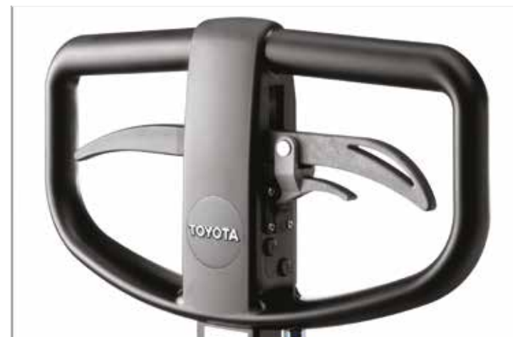
Ce mouvement est activé par le levier de commande situé sur la poignée
