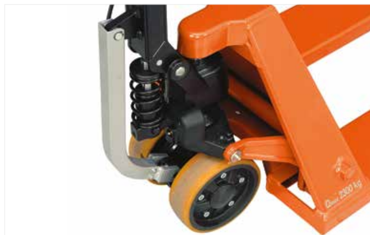
Le timon du BT Pro Lifter effectue un transfert de force vers les roues qui déclenche le mouvement du transpalette
