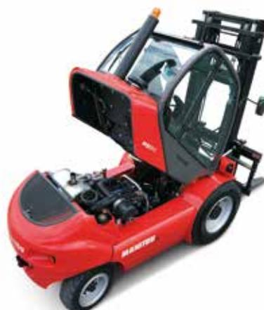
Sur les chariots MH, le relevage électro-hydraulique de la cabine rend aisé l'accès aux organes mécaniques pour effectuer la maintenance. Grâce à un seul bouton, votre cabine basculera en avant pour un entretien optimisé.
