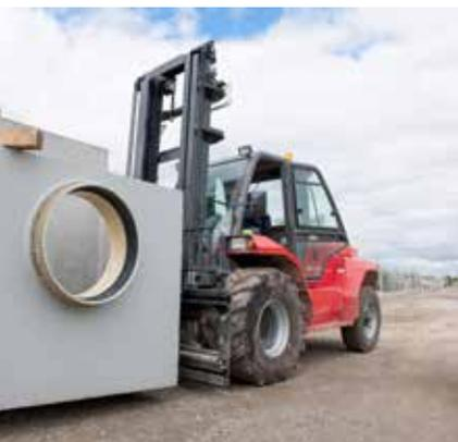
La cinématique particulière du MH avec son moteur positionné à l'arrière a permis de concevoir un chariot exceptionnel, compact (moins de 2m de haut) pour une capacité de 2 et 2,5 tonnes. Les MH sont équipés de moteur Kubota (48,6kW en stage 3B et 36 kW pour le MH en stage 3A).
