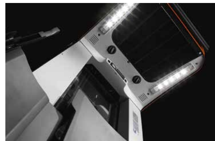
Toit de protection avec éclairage cabine à LED intégré
