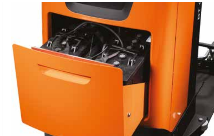
Remplacement rapide et facile de la batterie
