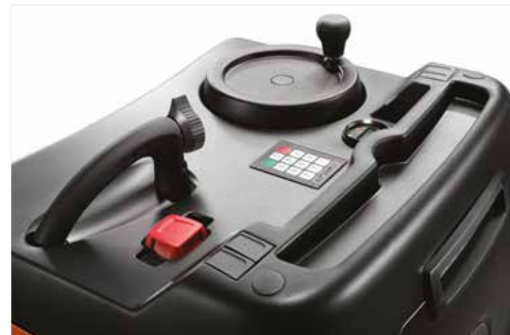
Petit volant de direction et accès par code PIN
