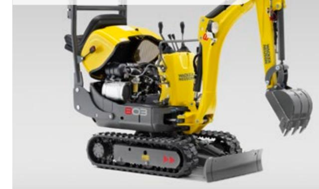
Transmission la plus puissante de sa catégorie, allée à un système hydraulique avec répartition de débit indépendant de la charge à déplacer (LUDV) pour une performance maximale et des manoeuvres précises
