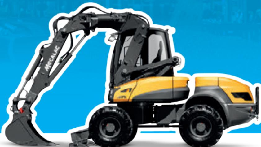
Pelle chargeuse sur pneus 10T Mecalac 12MTX
