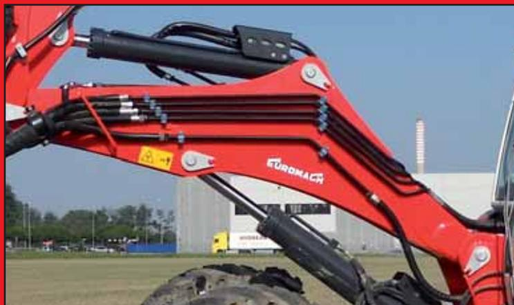
L'évolution de notre gamme de pelles araignées a donné naissance à une nouvelle forme du 1er bras. La pelle, avec une nouvelle cinématique de flèche et de télescope, est plus vite dans les opérations de creusage et plus agile dans la montagne parce qu'elle tourne dans la pente en maintenant le châssis prêt du sol.
