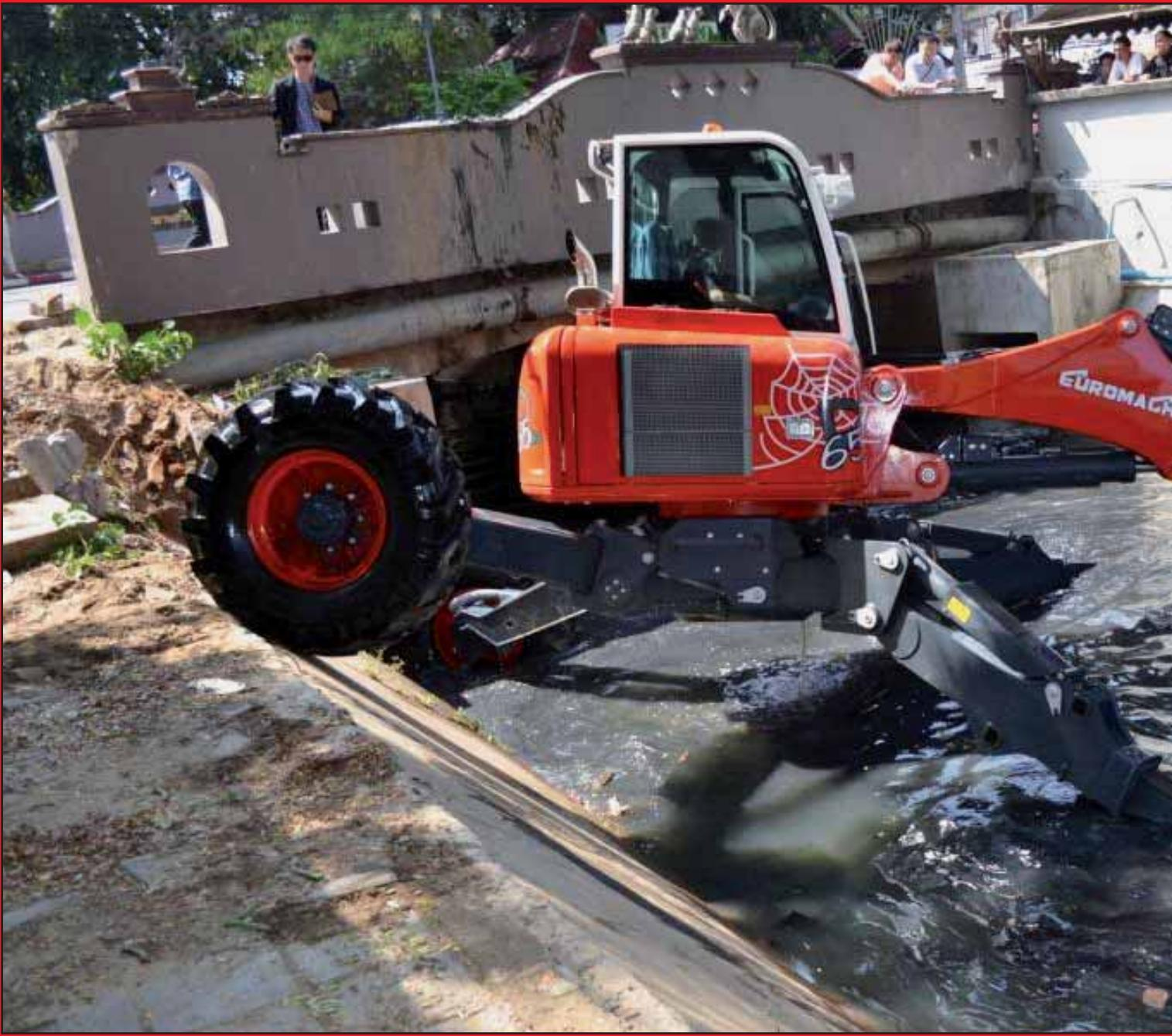
L'evoluzione dell'escavatore ragno ha portato a progettare una nuova forma del 1° braccio. Il braccio a boomerang e di maggior lunghezza, lo rende più versatile perché diventa veloce nello scavo come un escavatore cingolato e più agile nella montagna perché ruota nella pendenza pur mantenendo il telaio vicino a terra.
