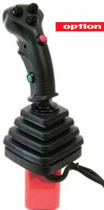
Abbiamo sviluppato con David Brown dei nuovi corpi manipolatori. Lo sforzo per comandare la leva è molto basso e la sensibilità sul movimento del cilindro molto maggiore.
