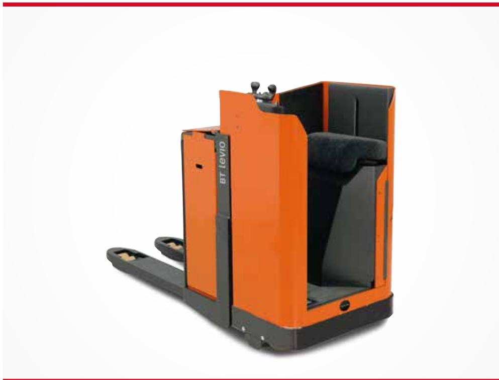
Chariot avec cabine entièrement fermée et position transversale de conduite pour faciliter les opérations dans les zones encombrées
