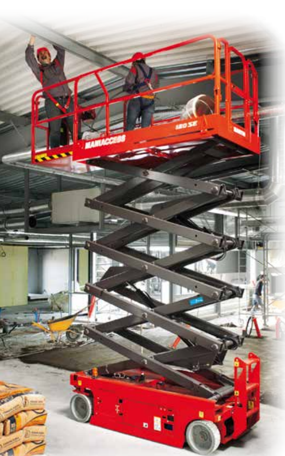
Nacelle électrique 120 SE
